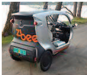
REN FRAMFART. Clean Motions elfordon Zbee är gjort i plast och har tre hjul, mc-styre och saknar dörrar.
